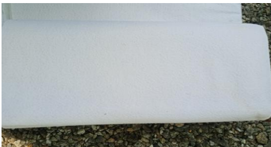
FIG.4 NON WOVEN GEOTEXTILE
