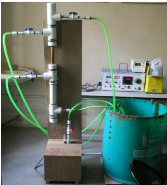
Fig.No-01 Actual heat pipe test setup image.
