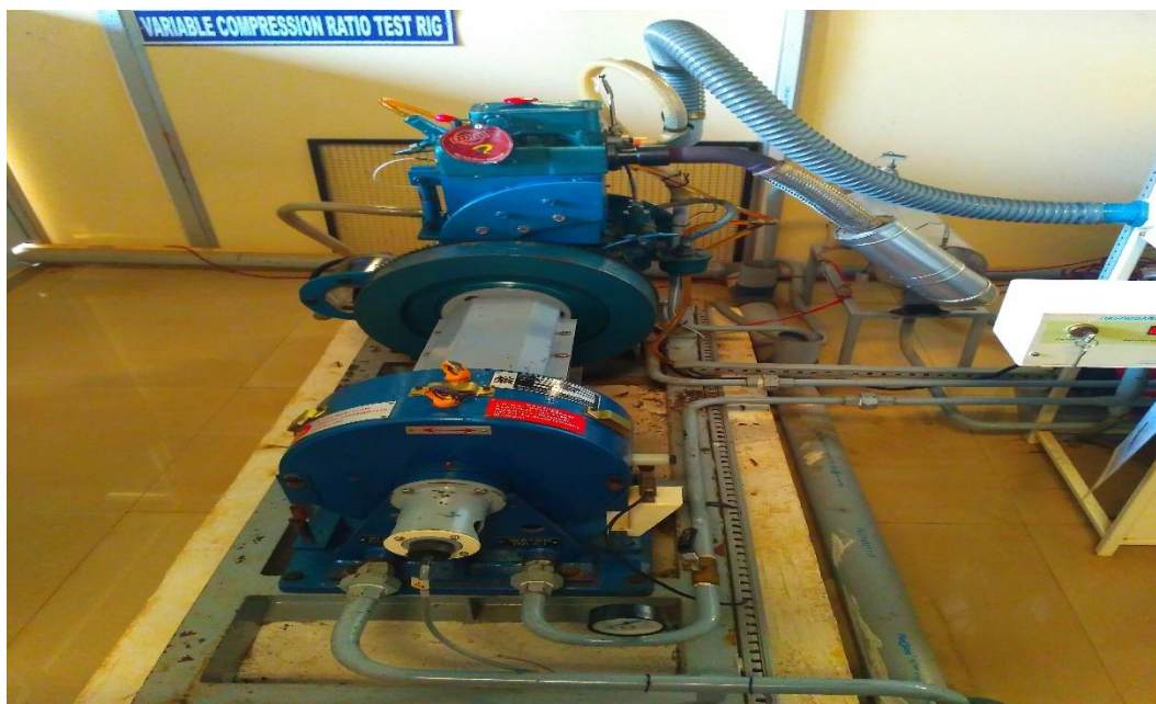
Fig.4.2. Eddy Current Dynamometer
