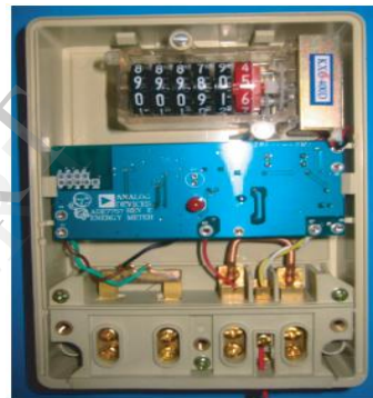
Fig: Energy Meter
