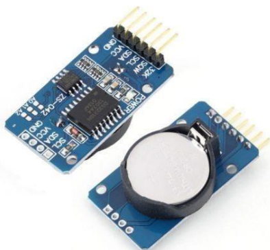
Fig4. RTC DS3231 Module
