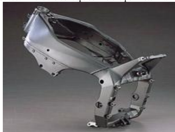
Fig: Perimeter Frame
