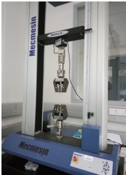
Fig 5: UTM (Tensile Testing)
