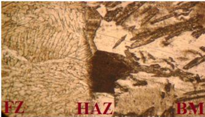
Fig. 8 (d) Microstructures of HAZ using ER309L filler metal in MIG welds (100×)
