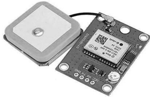
Fig. 4.UBLOX NEO-6M GPS module
